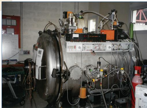
❖ Enceinte à vide INO permettant la réalisation de nombreux tests au sein du laboratoire.
