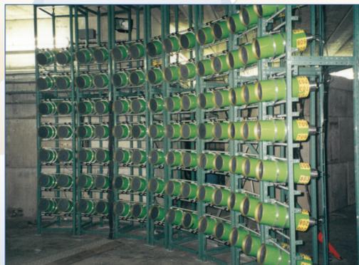
❖ Le détecteur modulaire de neutrons (DéMoN) composé de modules remplis de scintillateur liquide. Ce détecteur avait la particularité de pouvoir être installé dans différentes configurations géométriques.
