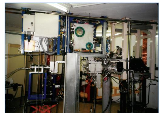
❖ Conception et réalisation d'une station d'identification pour la ligne SPIRAL au GANIL. Une bande aluminisée recueille les noyaux d'intérêt qui sont transportés devant des détecteurs.
