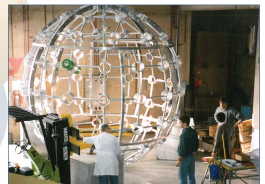
❖ Structure destinée au multidétecteur DéMoN et devant lui permettre d'opérer dans une configuration sphérique autour de la cible.
