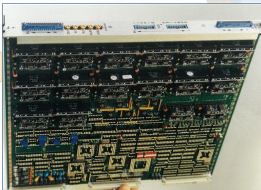
❖ Carte électronique au standard VXI conçue et réalisée en collaboration avec le LAL Orsay (*Carte Trigger INDRA*).
