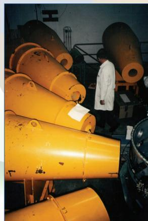
❖ Mesure de sections efficaces de production de neutrons lors de réactions induites par protons. Les modules du détecteur DéMoN sont entourés de larges cônes massifs destinés à diminuer le bruit de fond ambiant.
