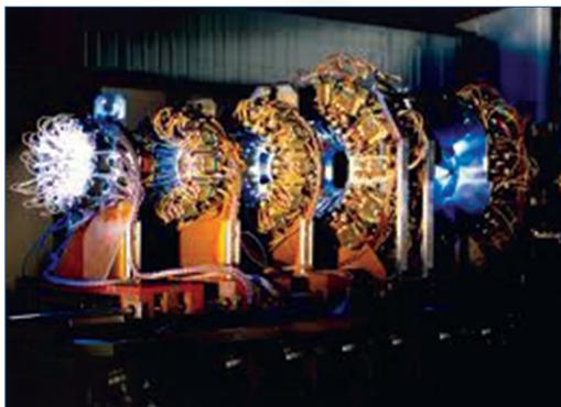
❖ Le multidétecteur INDRA (*Identification de Noyaux Avec Résolution Accrue*). Assemblage de scintillateurs plastiques, de chambres d'ionisation, de détecteurs silicium et de scintillateurs CsI agencés en 17 couronnes concentriques.
