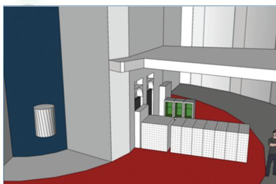
❖ SoLid : détecteur composé de milliers de cube de détection permettant de détecter les oscillations de neutrinos à courte distance auprès du réacteur nucléaire BR2 à Mol en Belgique.
