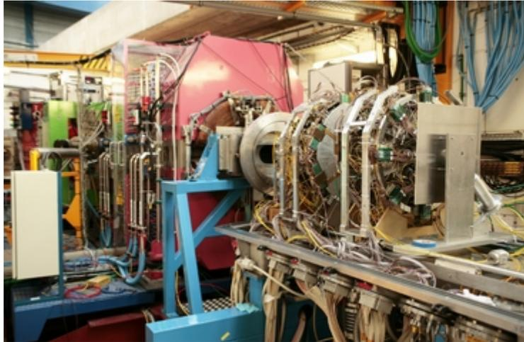
Figure 10: Montage INDRA-VAMOS dans la salle G1 du GANIL. INDRA est ici au premier plan et le spectromètre magnétique VAMOS se situe derrière en rose.
